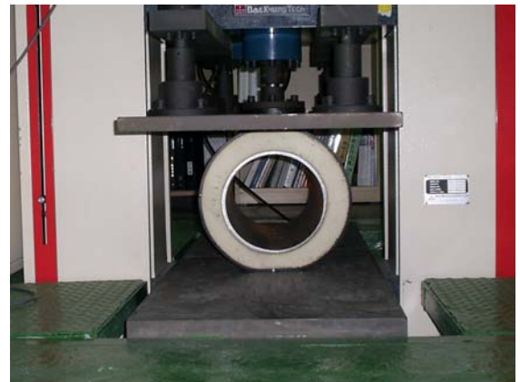
Fig. 1 압축강도 시험 모습
