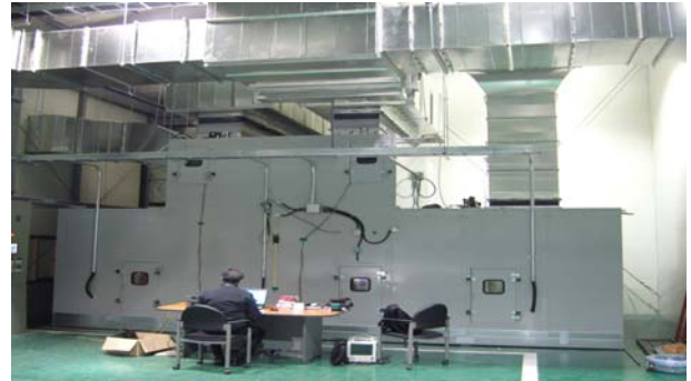
Fig. 1 성능실험을 위한 실험장치 전경
