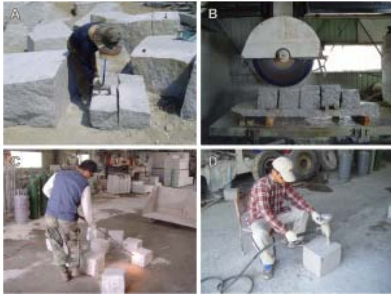
Fig. 1. 가공공정과정(A: 원석채취, B: 절단, C: 버너, D: 잔다듬)
