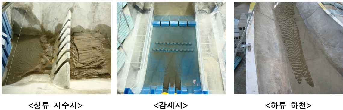
그림 4. 200년빈도 홍수량 방류시 배사 실험 결과
