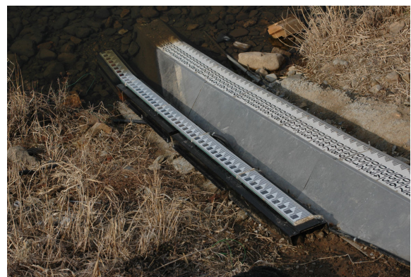
그림 6. 제방 경사면에 설치된 LED 수위표(왼쪽)
