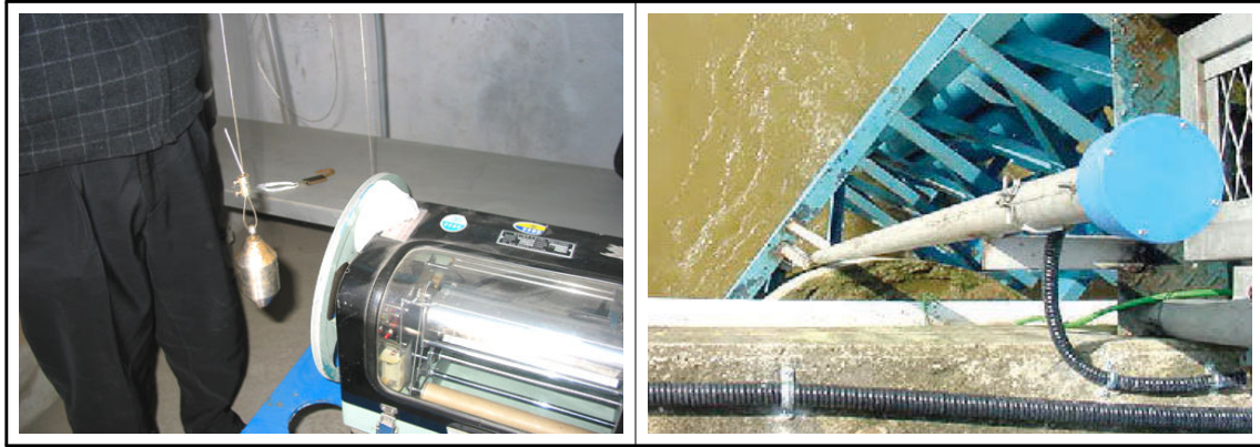
그림 2. 부자식 수위계 장비(좌), 초음파식 수위계(우)
