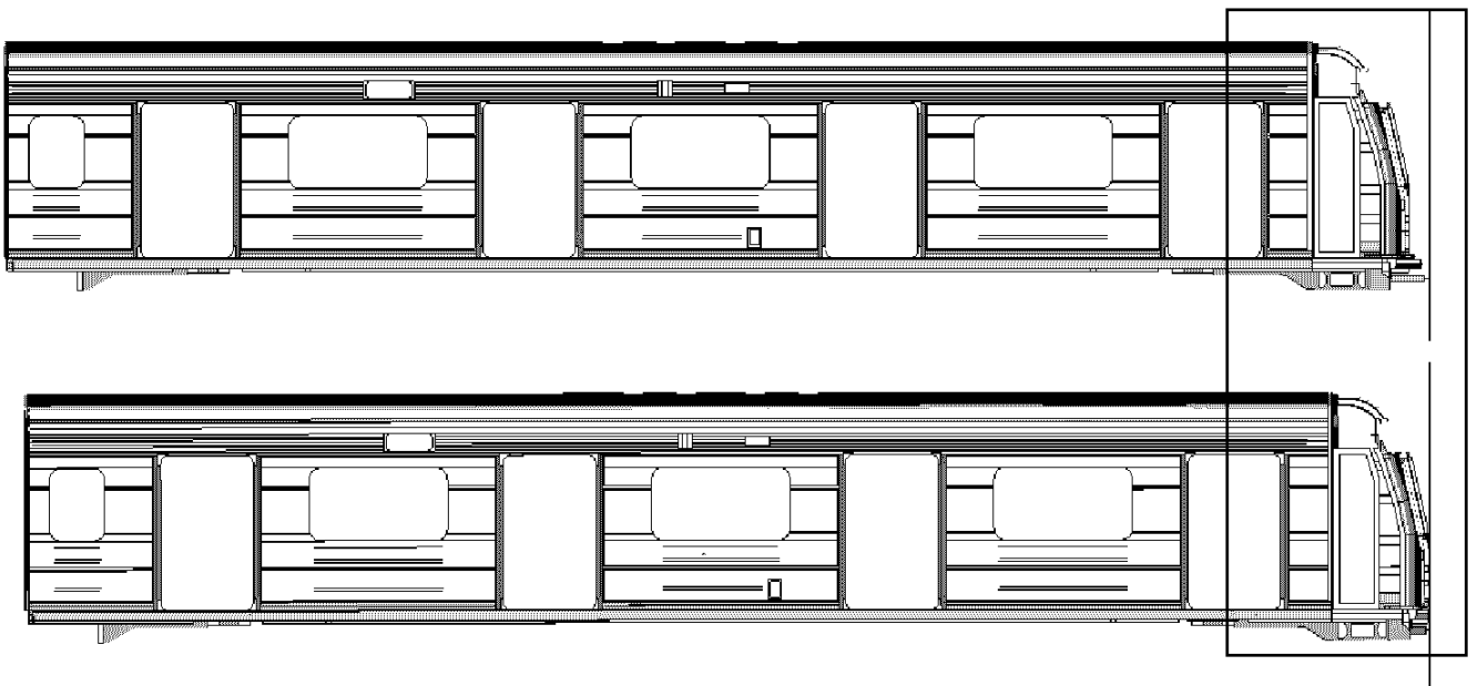
그림 5. 초기 상태와 충돌 후 전체 형상 (상대속도 20km/h)
