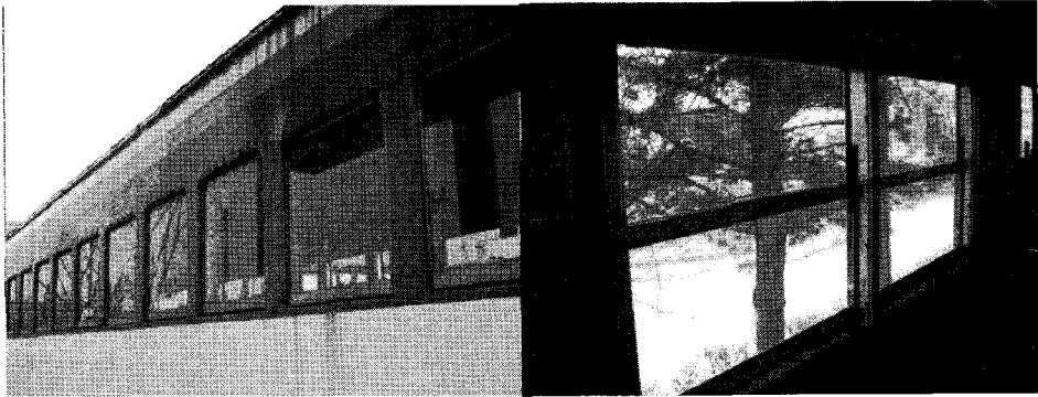
<사진2.2> 철도 차량 객실창문 일반 복층유리 및 단판유리 적용(무궁화구형(좌), 통일호(우))
