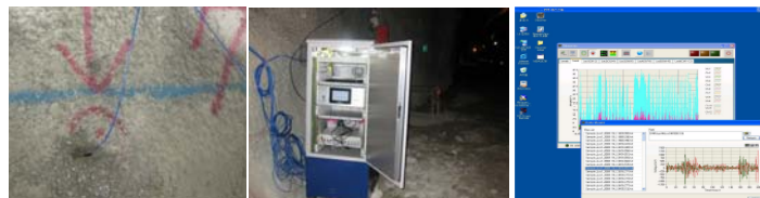
그림 4.5 센서설치, 터널내 계측시스템, 원격접속화면
