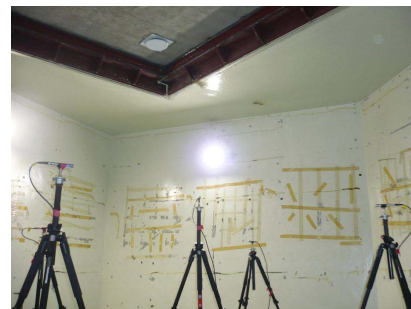
(b) HVAC Mock-up 잔향실 내부사진 그림 1. HVAC Mock-up 설치 사진
