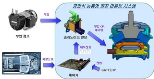
Fig.1 능동형 엔진마운팅 시스템의 구조
