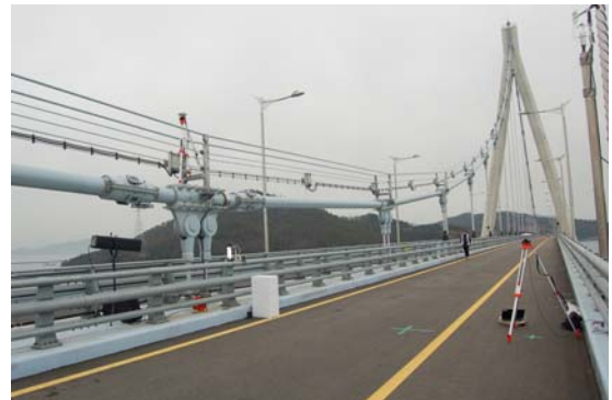
그림 2 DGPS 위치 측정 시스템
