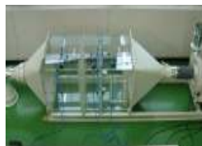
Fig 2. Fan performance test
