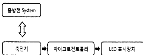
Fig. 1 축전지 잔류용량 표시장치의 구성도
