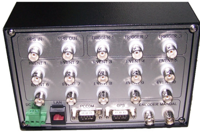
그림 2 후면. PPS IN/OUT, Trigger Port 3개, Event Port 10개, LAN 통신, PC 및 GPS 통신 시리얼 포트가 위치
