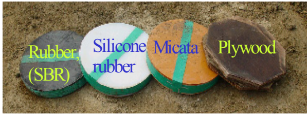
(a) 폴리우레탄 (b) 고무, 실리콘고무, 미카타, 합판 그림 2.3 말뚝쿠션재료의 설치 위치와 종류
