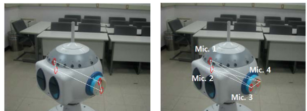
그림 1. 기존의 로봇 인공귀에 부착된 마이크로폰의 위치(좌)와 공간상으로 사상된 GCC 함수를 이용한 방식을 사용할 때의 마이크로폰의 위치(우)
