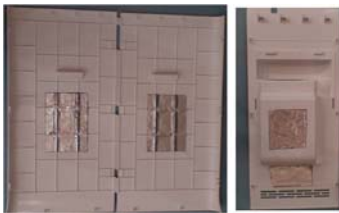
Fig.5 외부 패널 제진재 부착 위치
