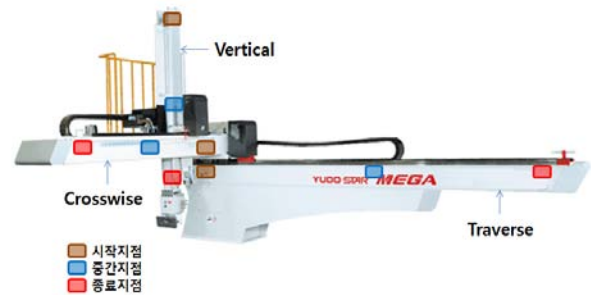
[그림. 1] 실험용 제조용 취출로봇
