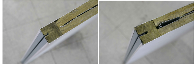
Fig. 4(a): 고차음(High Noise Reduction)패널(내부천공판1+ 공기층[5mm]) Fig. 4(b): 고차음(High Noise Reduction)패널(내부천공판2+ 공기층[10mm])
