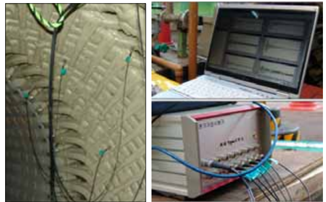
Fig. 3 발전기 고정자 단말부에 대한 모달 시험
