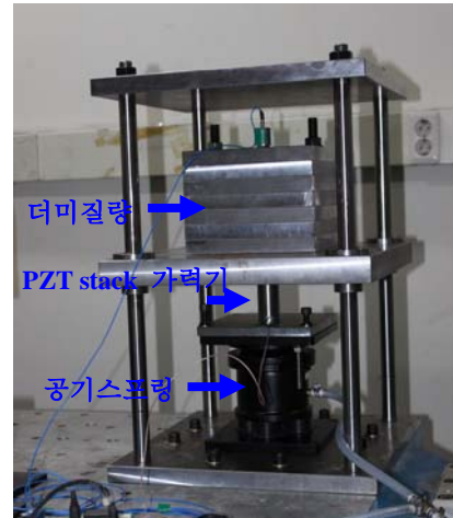
그림 2 PZT stack 가력기의 제어력 확인 실험
