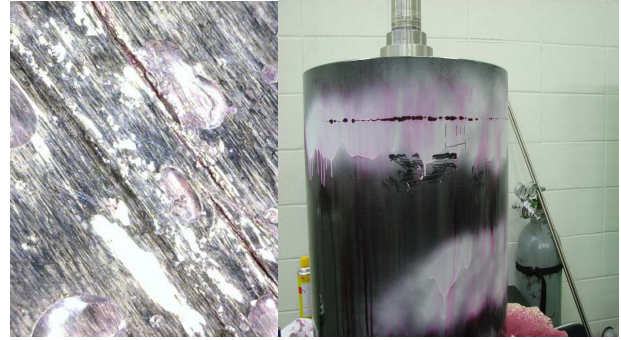
그림 5. 복합재 휠 균열 확대사진(좌) 및 PT검사 결과(우)
