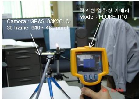
Fig. 2 열원판별을 위한 실험장치 구성사진 및 온도분포 확인을 위한 열화상 촬영
