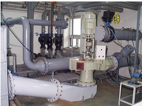
[그림 2] 프란시스수차모형의 성능시험
