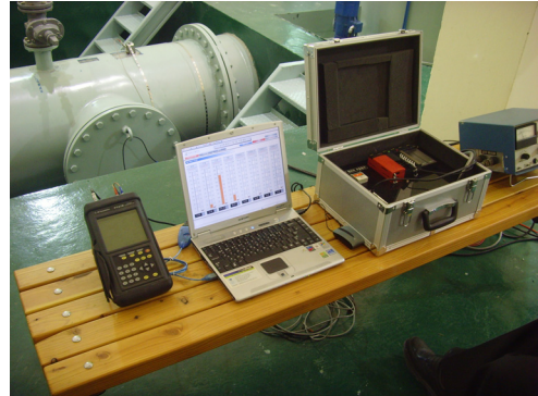
[그림 7] 수차발전기 성능측정장치 구성
