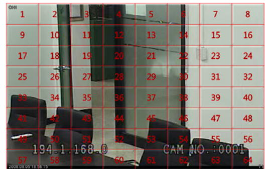
[그림 4] 정합 블록 기법을 이용한 움직임 검색
