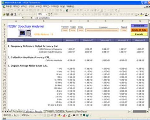
[그림 4.3] Spectrum Analyzer의 교정 결과
