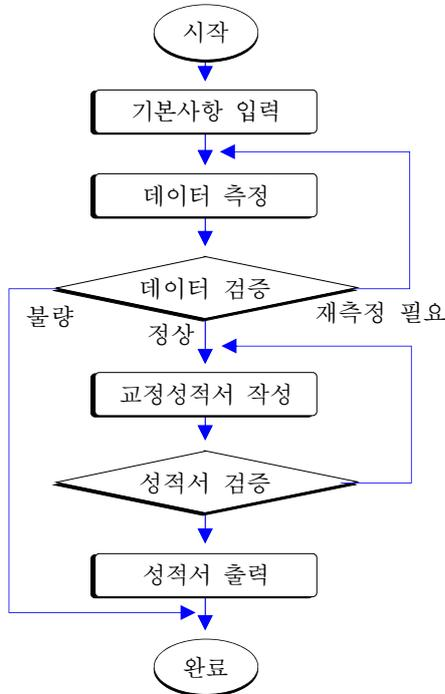
[그림 3.1] Calibration Process
