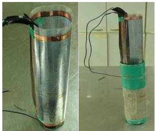
[그림 3] PVDF 필름 제작과 실험용 연직배수체
