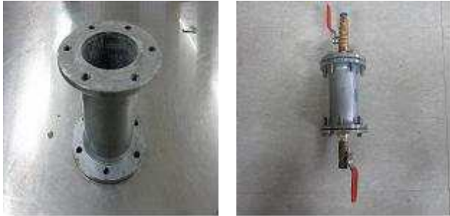
(a) 중력식 몰드 (b) 압력식 몰드 [그림 1] 부착력측정용 몰드
