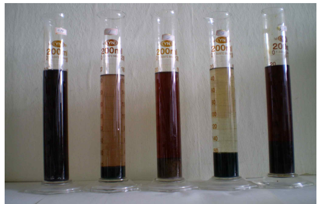
[그림 4] 응집제별 색 제거 효과 ①폐수, ②응집제, ③염화철, ④황산철, ⑤황산알루미늄
