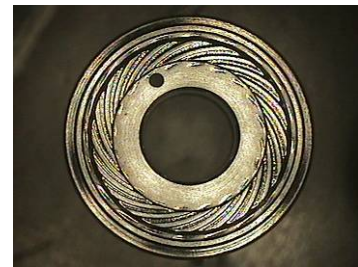
number of groove : 20 ea., angle : 20°, depth : 15µm
