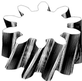
(b) Helical gear (m : 2.5,  $\alpha$  : 20°,  $\beta$  : 25°, Z : 10)
