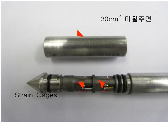
그림 4. 삼성 MCPT 시스템에 사용된 소형콘
