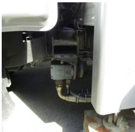
그림 10. 삼성 MCPT 조사차량에 설치된 유압장치
