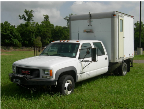
그림 6. 연속관입형 MCPT 지반조사차량: LTRC 방식(왼쪽) 및 Sage Engineering 방식(오른쪽)
