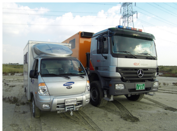
그림 8. 삼성 MCPT 조사차량(왼쪽)과 일반 CPT 조사차량(오른쪽)
