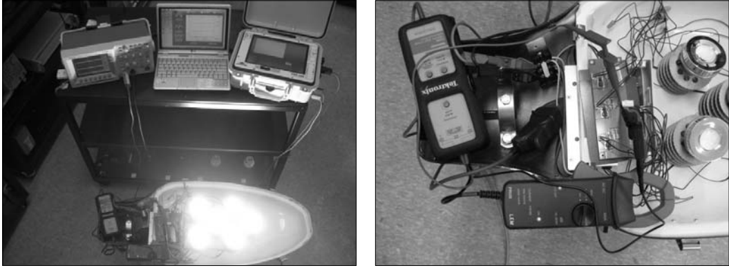
Fig. 1. LED 가로등(내장형)의 전기적 특성 측정 모습
