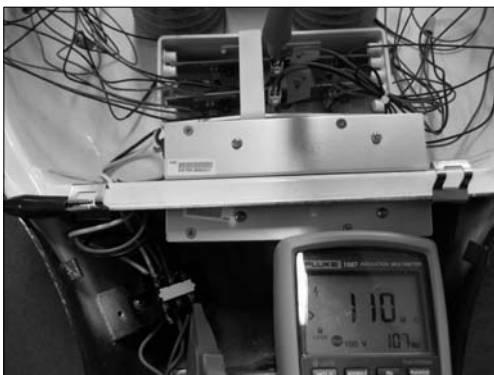
(e) 컨버터 1차측(line2)과 2차측의 절연저항 측정(100V)
