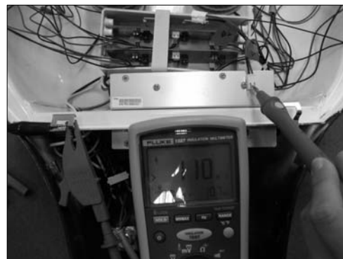
(c) 컨버터 2차측과 외함의 절연저항 측정(100Vdc 인가)
