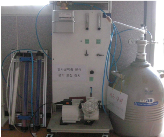
그림 2. 흡착기를 이용한 대기 중 노블가스 포집
