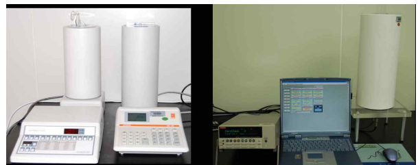
그림 2 상용 이온 챔버(Atomlab100, Capintec crc-15r), 자체 제작 이동형 표준기
