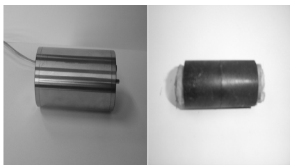
(a): Motor Ass'y (b): Core Ass'y 〈그림 5〉 SMC적용 모터 코어 시작품 사진
