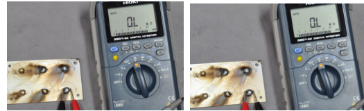
(a) 순방향 (b) 역방향 <그림 6> 강한 화염에 의해 소손된 경우
