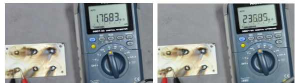
(a) 순방향 (b) 역방향 <그림 7> 약한 화염에 의해 소손된 경우
