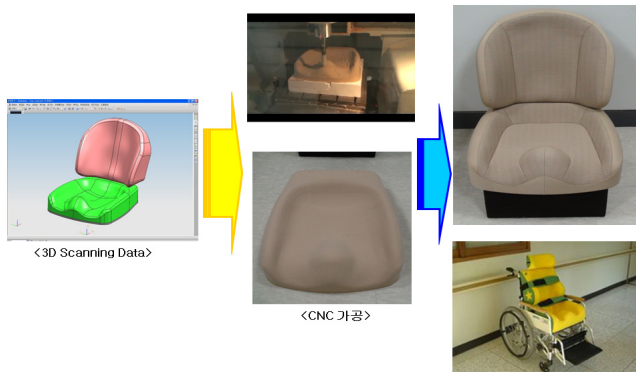
〈그림 5〉 CNC 가공을 통한 개인 맞춤형 시트 제작 과정
