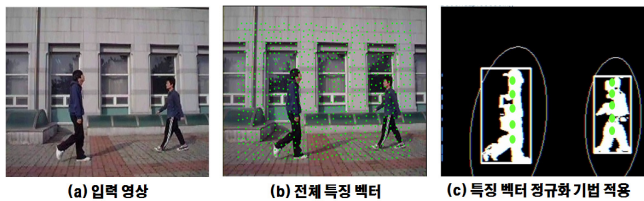
그림 1. (a) 입력 영상 (b) KLT 알고리즘 이용한 특징 벡터 추출 (c) 특징 벡터 1차 정규화
