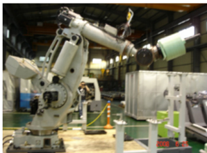
<그림 3> 600kg 초 중량물 로봇
