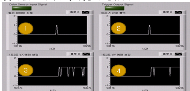
<그림 8> dX,dY에대한 에러보정 파형
