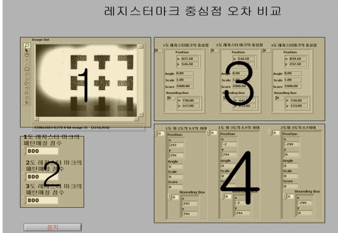
<그림 5> 레지스터마크 중심점 오차 측정
