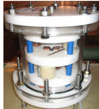
<그림 1> 2단 Fast Marx generator
