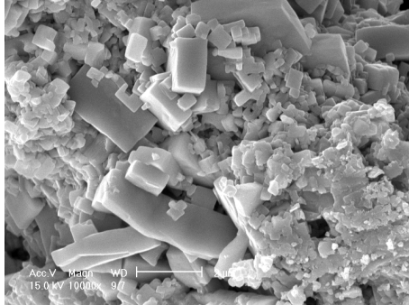
그림 2. 1100°C로 소결한 BNT/BT 후막의 표면 구조
