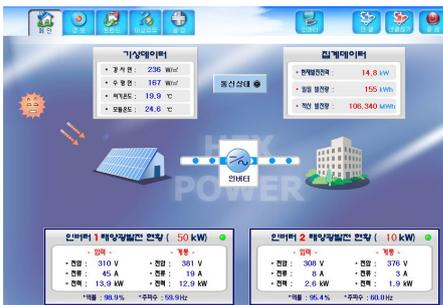
그림 4 태양광발전 모니터링 시스템 메인화면
