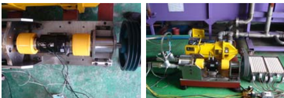
〈그림 5〉 가변속유체토크 컨버터 발전시험 사진
