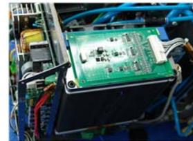
〈그림 6〉 Fuel Cell Stack Monitoring Driver
