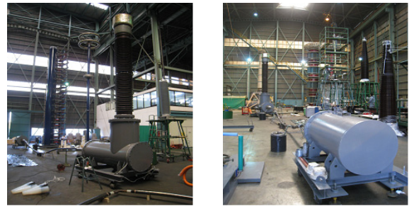
(a) 뇌 충격 내전압 시험선로 (b) 상용주파내전압 시험선로 <그림 8> 전기적 특성평가 시험선로
