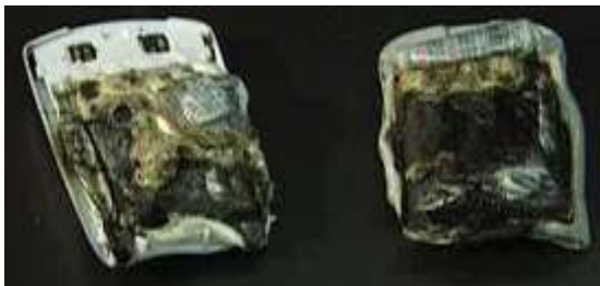
그림 1 배터리의 폭발 Fig. 1 Explosion of Li-ion Battery
