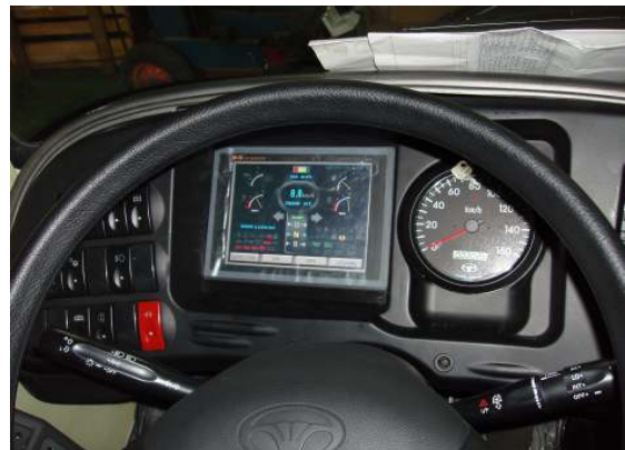
그림 10 실제 SHEV버스에 장착모습 Fig. 10 Photograph of SHEV bus with touch panel
