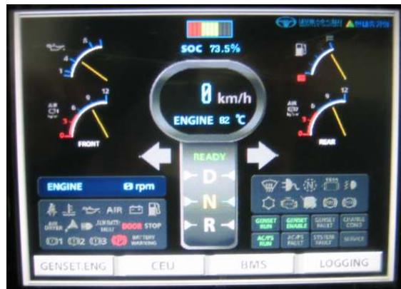
그림 9 터치패널 화면 Fig. 9 Screen of touch panel
